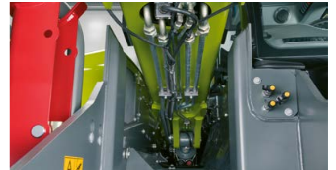
Seitliche Teleskoparmführung serienmäßig im Rahmen integriert bei allen Ladern über 4.500 kg Tragkraft
