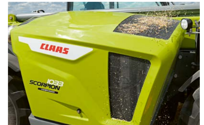
Vermeidung von Kühlerverschmutzung dank Reversierlüfter
