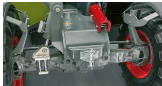
Mehr Sicherheit im Gelände durch hydraulischen Niveaueingleich
