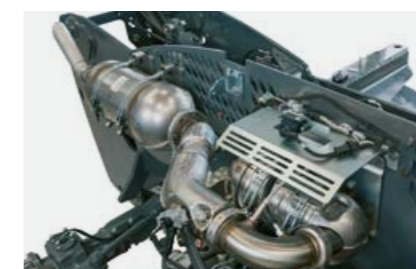
Der Dieselpartikelfilter regeneriert automatisch.
