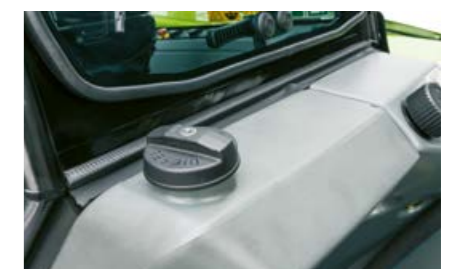
Abschließbarer Kraftstofftank hinter der Kabine
