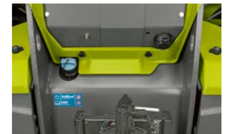
Gut zugänglicher AdBlue®-Einfüllstutzen zur effizienten Abgasnachbehandlung
