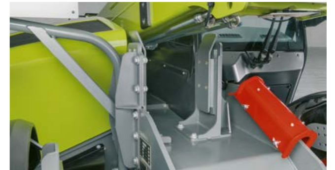
Seitliche Teleskoparmführung verfügbar für alle SCORPION Modelle
