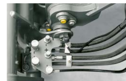
Hydraulikanschlüsse sicher untergebracht am Geräteträger
