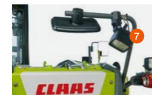
Halogenscheinwerfer am Halter des Heckspiegels zur Ausleuchtung des Rückraums
