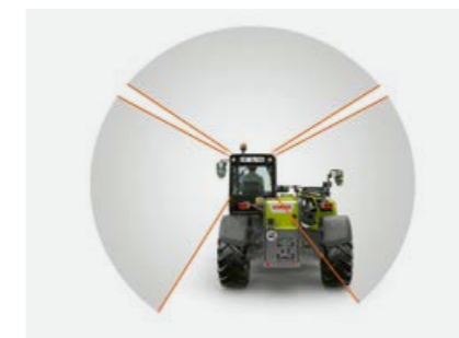
Ungehinderter Blick nach hinten durch tief angelegten Teleskoparm – für mehr Arbeitssicherheit
